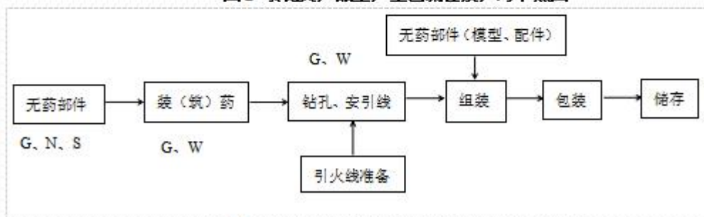
图3 造型玩具类产品生产工艺流程及产污节点图
